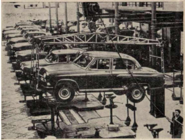
Сборка автомобилей «Волга» на Горьковском автозаводе
